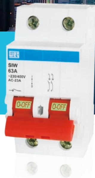
Los interruptores seccionadores SIW poseen las mismas estructuras de los minidisjuntores MDW en las versiones bipolar, tripolar y tetrapolar, no obstante, son desprovistos de los disparadores térmicos y magnéticos. Su función es seccionar circuitos eléctricos con corrientes hasta 100 A, conforme la norma IEC 60947-3. Los seccionadores SIW **cuentan con bloques de contacto auxiliar y Trabacandado**, suministrados como accesorios.
